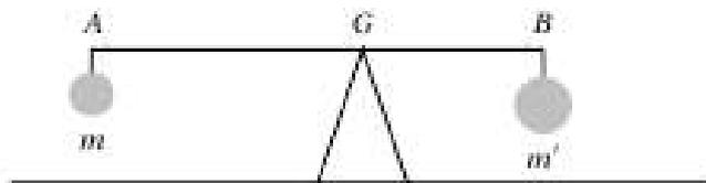
Sur une tige de masse négligeable, on suspend deux masses  $m$  et  $m'$  en  $A$  et en  $B$ . Comment positionner le pivot  $G$  pour que l'ensemble soit en équilibre ?
